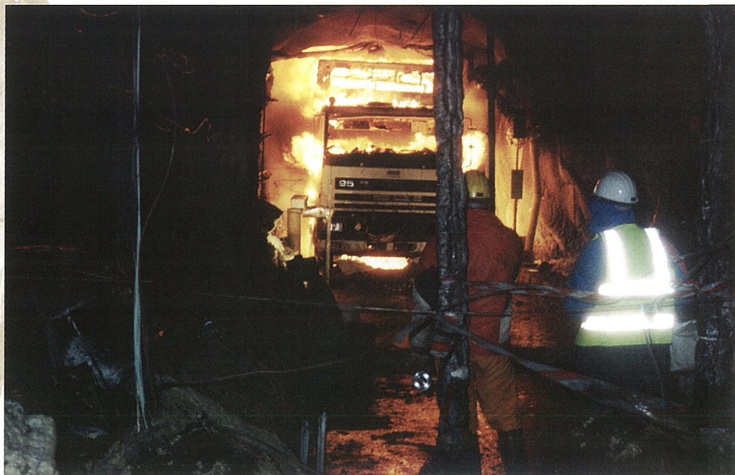
Feltforsøk ved brann i bil i tunnel. Foto: Arkiv.
