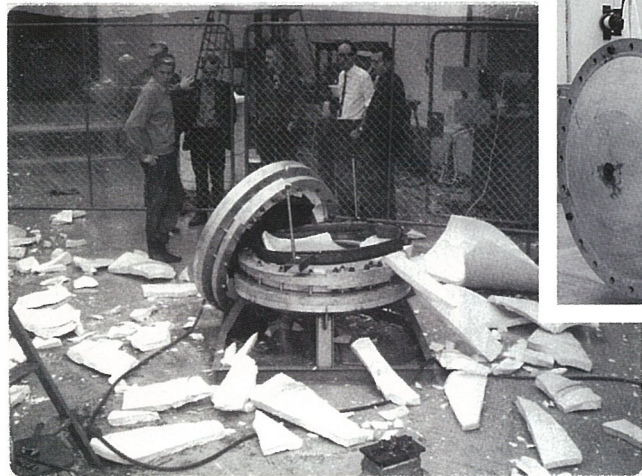
1967: Trykkprøving av porselensprøvecelle for SF 6 endte med kollaps. Heldigvis foregikk prøven med vann. En ståltank erstattet porselenscellen. Foto: H. Danielsen.
